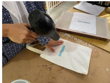
Gambar 5. Mengeringkan tinta setelah diaplikasikan (Sumber: Muhammad Farhan, 2025)
